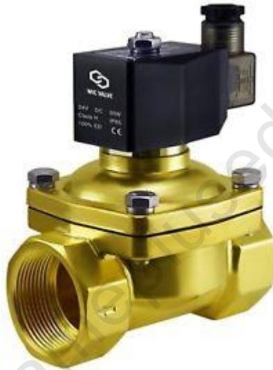
솔레노이드에 전류가 흘러 자기장이 형성되면 근처의 철제 물체에 인력을 작용하는 성질을 이용하여 관의 개폐를 전기적 신호로 제어할 수 있는 밸브를 만들 수 있습니다. 압축공기의 유압을 제어하여 자동으로 문을 열고 닫는 버스의 개폐문이나 정수기에서 쓰이는 자동 냉, 온수 잠금장치 등이 이러한 솔레노이드 밸브를 사용하고 있습니다. 또한 버튼을 눌렀다 놓을 때 흐르는 전류를 이용해 철제 종을 쳐서 소리를 내는 현관문의 알림벨도 이러한 솔레노이드의 특성을 이용합니다.
