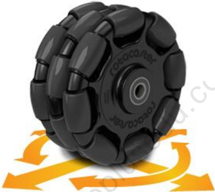
옴니 휠 혹은 폴리 휠은 메카넘 휠과 비슷하게, 둘레에 회전방향에 수직으로 작은 날개 바퀴가 달려있는 바퀴입니다. 바퀴는 빨리 움직일 수 있으며 쉽게 측면으로 슬라이드할 수 있습니다. 종종 홀로노믹 주행 시스템에 이용되기도 합니다.
